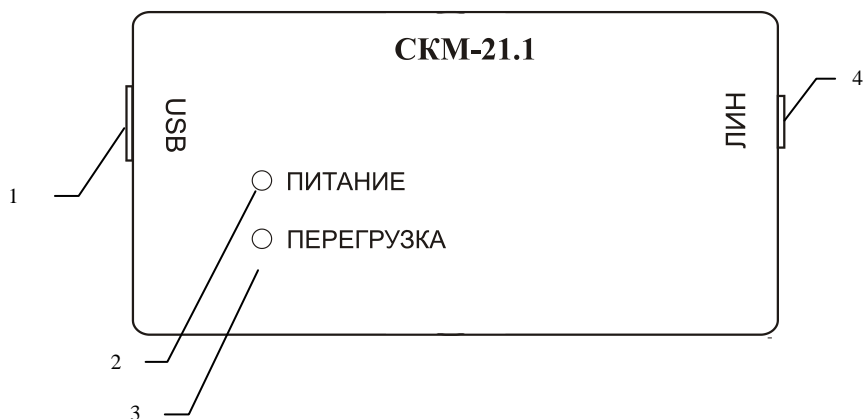
Рисунок 3 - Общий вид и расположение элементов индикации и разъемов блока СКМ-21.1
